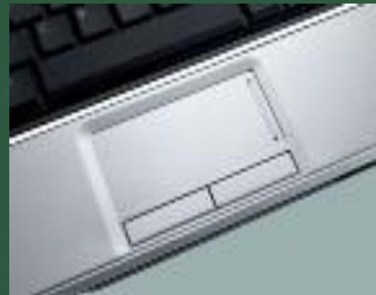
В портативных компьютерах вместо манипуляторов используется сенсорная панель, перемещение пальца по поверхности которой преобразуется в перемещение курсора на экране монитора. Нажатие на поверхность сенсорной панели эквивалентно нажатию кнопки мыши.
