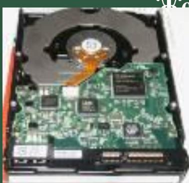
**Жесткий диск** (*винчестер*) – устройство хранения информации, основанное на принципе записи основным магнитной накопителем данных в компьютеров.
