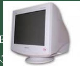
Монитор является универсальным устройством в информационной системе. В настольных компьютерах до сих пор используются **мониторы на электронно-лучевой трубке**. Но такие мониторы могут являться источником вредных для человека излучения. Современные мониторы соответствуют санитарно-гигиеническим требованиям. В современных настольных, портативных и карманных компьютерах применяют **плоские мониторы на жидкокристаллических кристаллах**,
