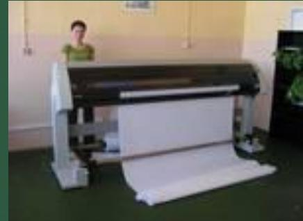
**Плоттер (графопостроитель)** - устройство для автоматического вычерчивания с большой точностью рисунков, схем, сложных чертежей, карт и другой графической информации на бумаге размером до А0 или кальке.
