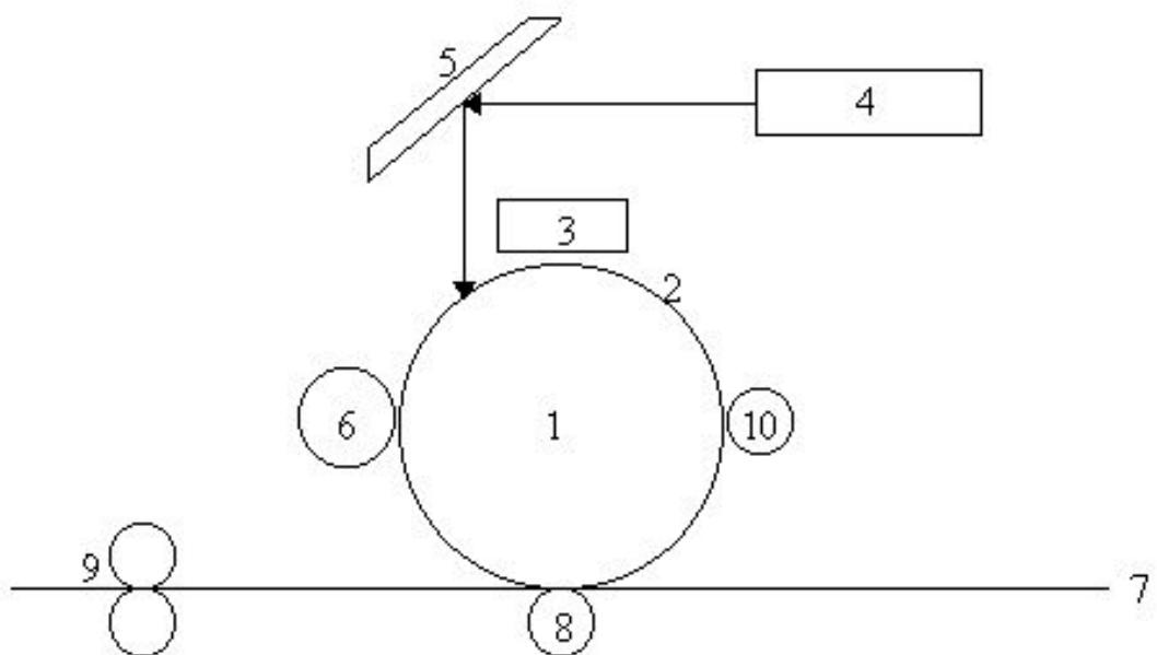
1. Каждая частица полупроводниковой пленки [2], нанесенной на металлический цилиндр фотонаборного барабана [1] заряжается отрицательно с помощью коронатора [3].
