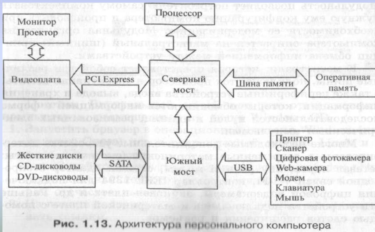
**Пропускная способность шины.** Быстродействие процессора, оперативной памяти и периферийных устройств существенно различается. Быстродействие устройства зависит от тактовой частоты обработки данных (обычно измеряется в мегагерцах — МГц) и разрядности,
