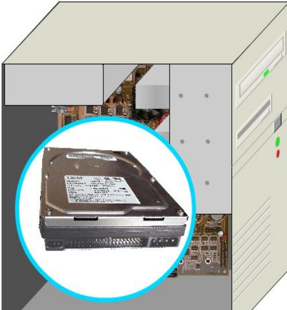
Здесь же вмонтирован жесткий магнитный диск (винчестер) - основное запоминающее устройство компьютера.
