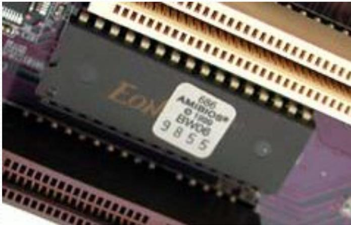
**ПЗУ (постоянное запоминающее устройство)** - память, предназначенная для хранения микропрограмм, которые используются при включении компьютера (когда оперативная память ещё не задействована) для тестирования его компонентов.
