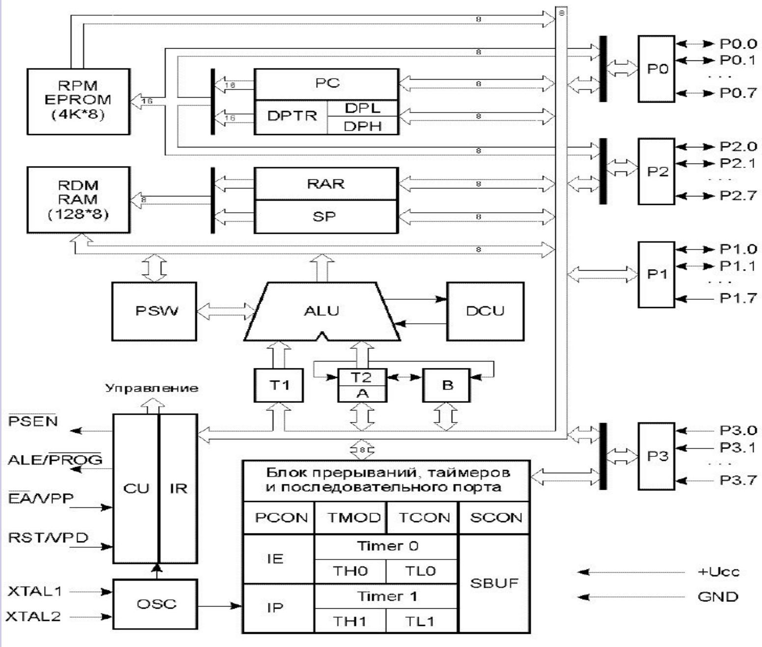
Таким образом, ALU может оперировать четырьмя типами информационных объектов: булевыми (1 бит), цифровыми (4 бита), байтными (8 бит) и адресными (16 бит). В ALU выполняется 51 различная операция пересылки или преобразования этих данных. Так как используется 11 режимов адресации (7 для данных и 4 для адресов), то путем комбинирования операции и режима адресации базовое число команд 111 расширяется до 255 из 256 возможных при однобайтном коде операции.
