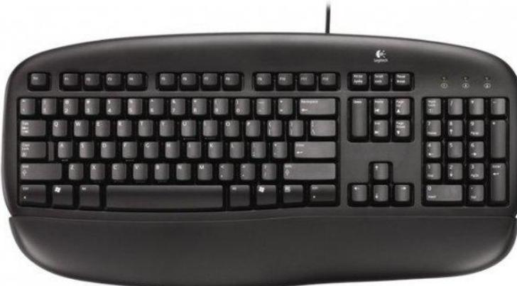
Двенадцать функциональных клавиш расположены в верхней части клавиатуры. Ниже располагается блок алфавитно-цифровых клавиш. Правее этого блока находятся клавиши управления курсором, а с самого правого края клавиатуры — цифровая панель.
