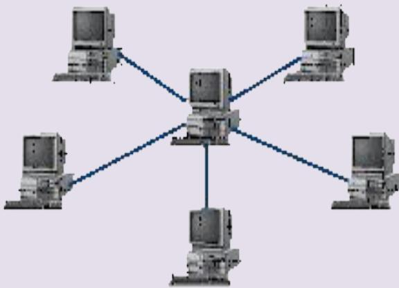
**Звезда** - такая топология, в которой все компьютеры подсоединены к сегментам, исходящим из одной точки – центрального узла. Вся информация передается через центральный узел. Эта конфигурация наиболее популярна для современных сетей. Связующим звеном такой сети является концентратор сети – хаб или коммутатор (свитч). Достоинство сети «+» - высокая степень защиты информации. Недостаток «-» - выход из строя ЦУ ведет за собой отказ работы всей сети.
