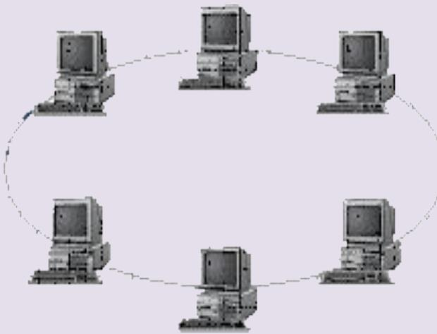
**Кольцо-топология**, в которой все компьютеры подсоединены вдоль сегмента кабеля, замкнутого в кольцо. Информация по кольцу передается от узла к узлу. Принимающий узел распознает и получает только адресованные ему сообщения. Само кольцо в современных сетях скрывается внутри маленького устройства, который называется модуль.
