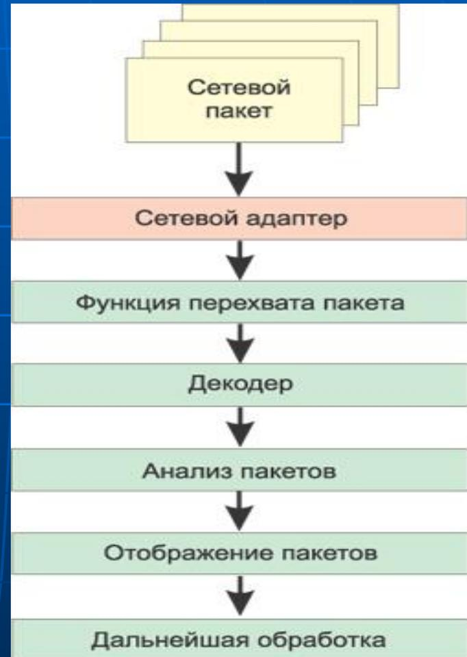
Прослушивание возможно благодаря особенности архитектуры сети Ethernet (IEEE 802.3). Архитектура большинства локальных сетей основана на технологии Ethernet (ether – эфир, network – сеть), в которой все устройства подключены к одной среде передачи данных и совместно её используют. Топология сети Ethernet – линейная или звездообразная, а скорость передачи данных 10, 100 и 1000 Мбит/сек.
