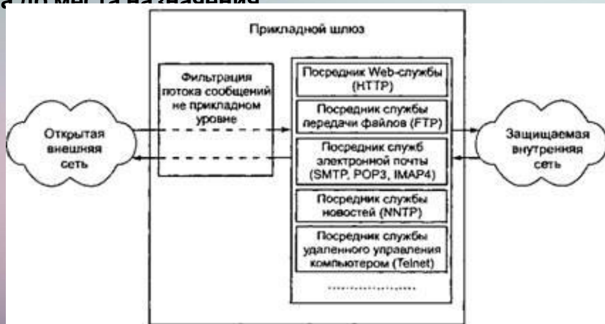
Рис. 9.6. Схема функционирования прикладного шлюза
