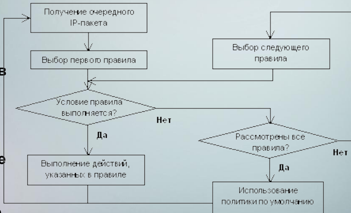
Рис. 3. Модель функционирования простого фильтра пакетов
