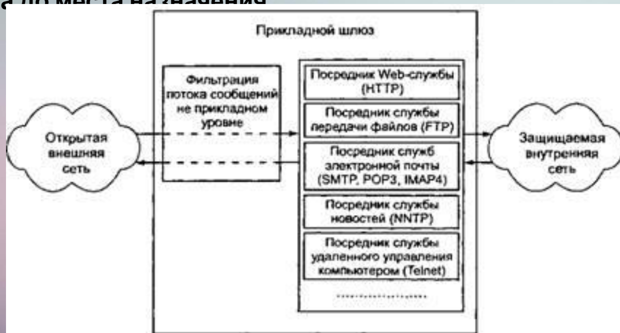
Рис. 9.6. Схема функционирования прикладного шлюза
