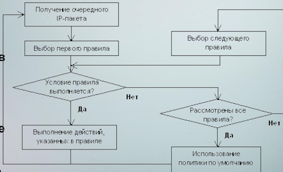
Рис. 3. Модель функционирования простого фильтра пакетов
