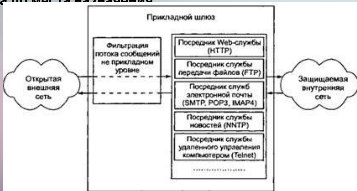
Рис. 9.6. Схема функционирования прикладного шлюза
