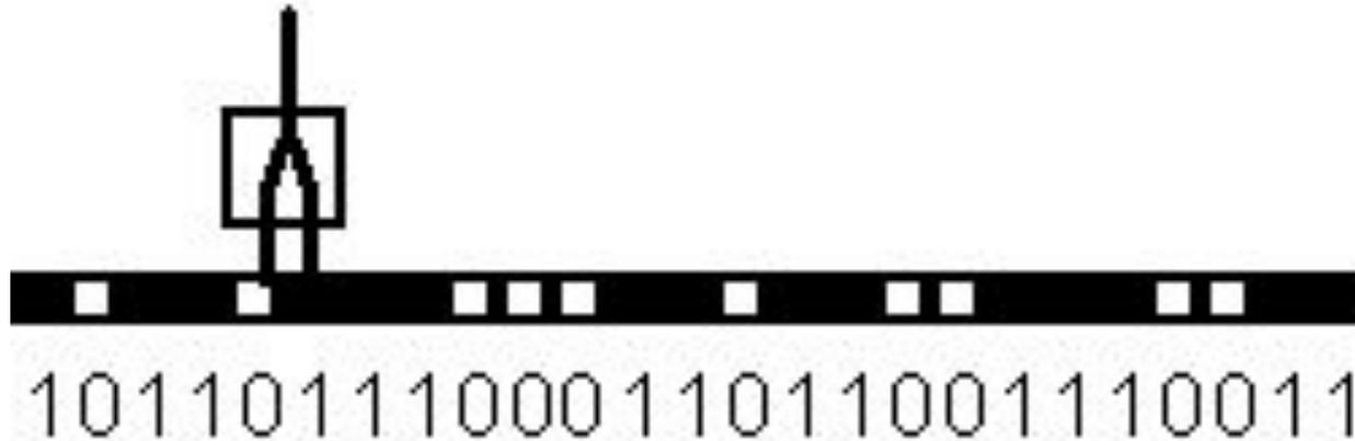
Формальный нейрон с двумя входами, занятый обработкой образа в виде одномерной цепочки черных и белых клеток.
