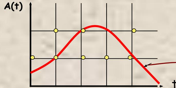
В процессе кодирования непрерывного звукового сигнала производится его временная дискретизация. Непрерывная звуковая волна разбивается на отдельные маленькие временные участки, причем для каждого такого участка устанавливается определенная величина амплитуды. Непрерывная зависимость амплитуды сигнала от времени  $A(t)$  заменена гладкой кривой на последовательность «ступенек»
