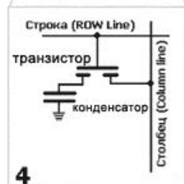
Устройство одной ячейки памяти
