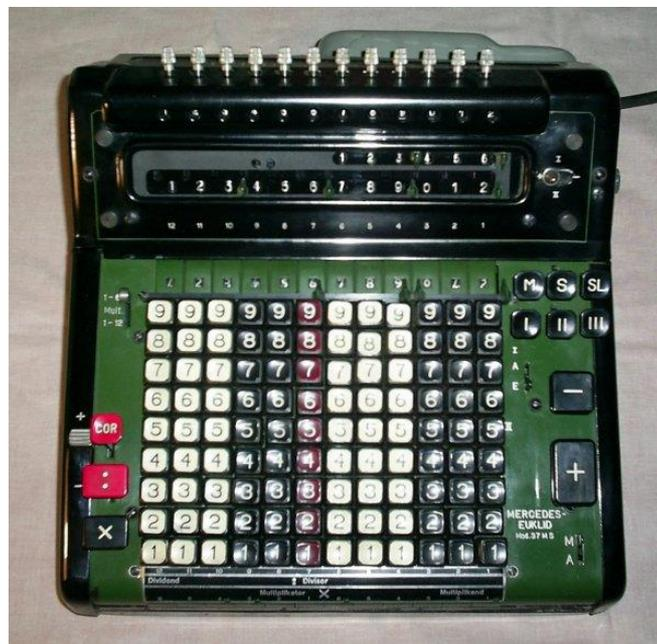
**На смену арифмометрам с «ручным» приводом пришли механические вычислительные машины с электрическим приводом. Эти машины уже имели удобный клавишный набор чисел**
