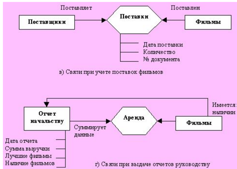
Рис.3.6. Построение фрагментов ER-модели при анализе информационных процессов
