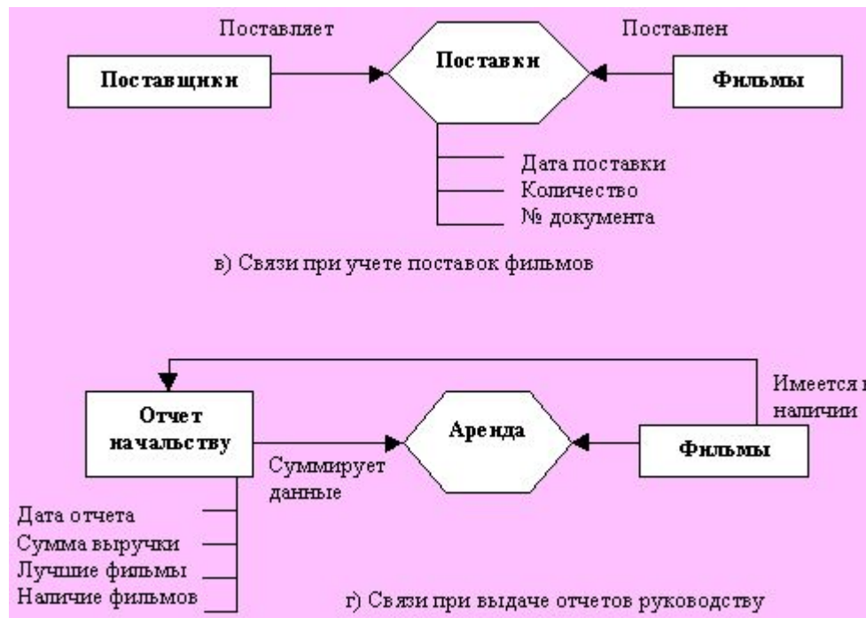
Рис.3.6. Построение фрагментов ER-модели при анализе информационных процессов
