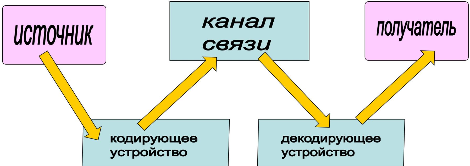
устройство, предназначенное для преобразования исходного сообщения источника информации к виду, удобному для передачи
