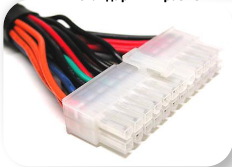
ATX с 24 контактами (Extended ATX)
