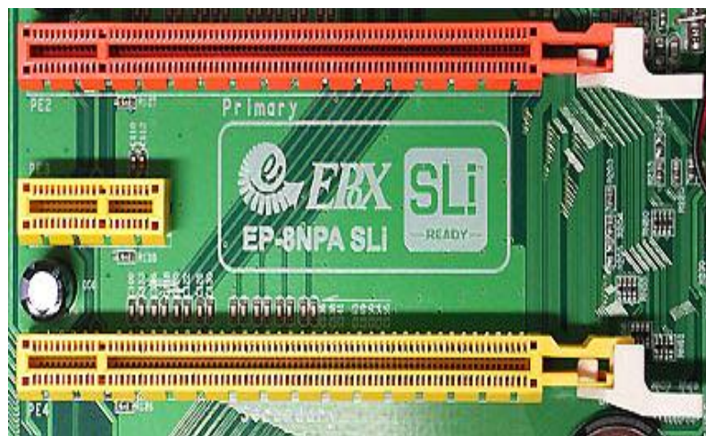
Два слота PCI Express для установки двух карт nVidia
