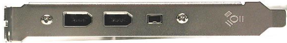
Карта FireWire обеспечивает два 6-контактных порта и один 4-контактный
