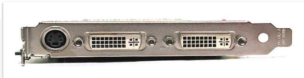
Видеоадаптер с двумя DVI может работать одновременно с двумя мониторами
