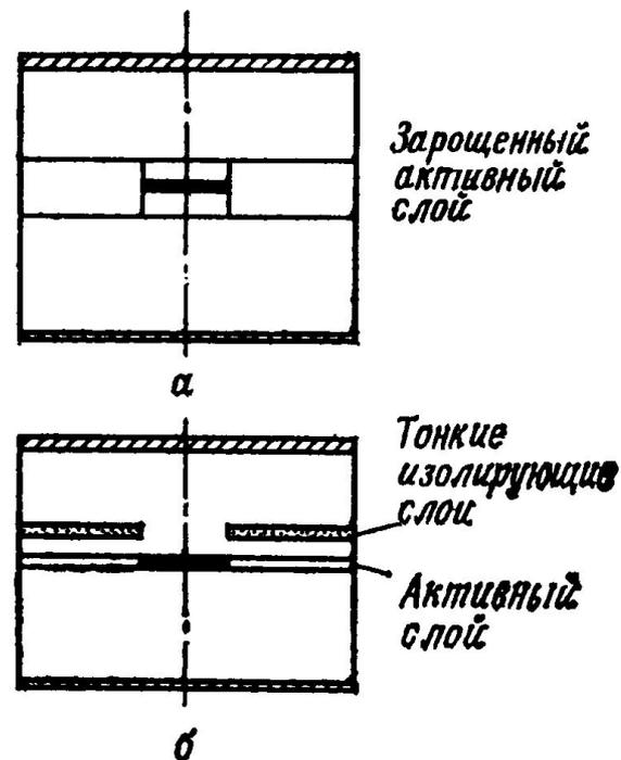
*a* — поперечное сечение полупроводникового лазера, удерживающего излучение в боковом направлении благодаря специальному профилю показателя преломления (встроенный волновод); *б* — лазер с волноводным эффектом в плоскости *p-n*-перехода, который обусловлен направляющим эффектом усиления.
