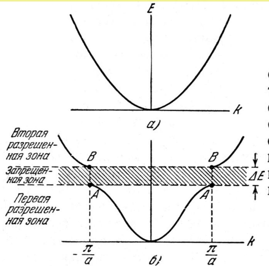
$a$ —график зависимости энергии от волнового числа для свободного электрона;  $б$  — график зависимости энергии от волнового вектора для цепочки из одинаковых атомов (линейная решетка) с расстоянием между атомами (постоянной решетки), равным  $a$ . Показана энергетическая щель, обусловленная первым брэгговским отражением при  $k = \pm \pi/a$ .
