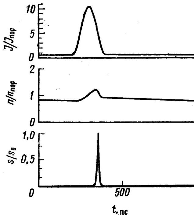
Образование сверхкороткого импульса вследствие нелинейности при возбуждении полупроводникового лазера коротким импульсом тока. Ширина импульса тока 100 пс, ширина оптического импульса 10 пс.  $J$  — плотность тока,  $n$  — концентрация носителей,  $s$  — концентрация фотонов.
