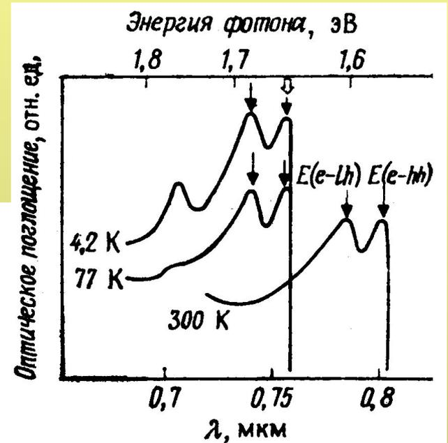
Спектры оптического поглощения в сверхрешетке структуры GaAs — AlAs при различных температурах ( $L_z = 54 \text{ \AA}$ ; нелегированная; для удобства наблюдения спектры параллельно смещены по оси ординат).
