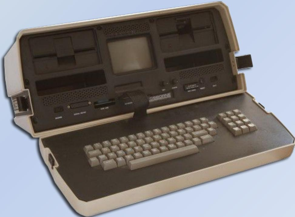
Весил 11 килограммов, комплектовался двумя приводами 5.25 – дисков, имел откидную клавиатуру-крышку, пятидюймовый монитор и ручку для переноски.
