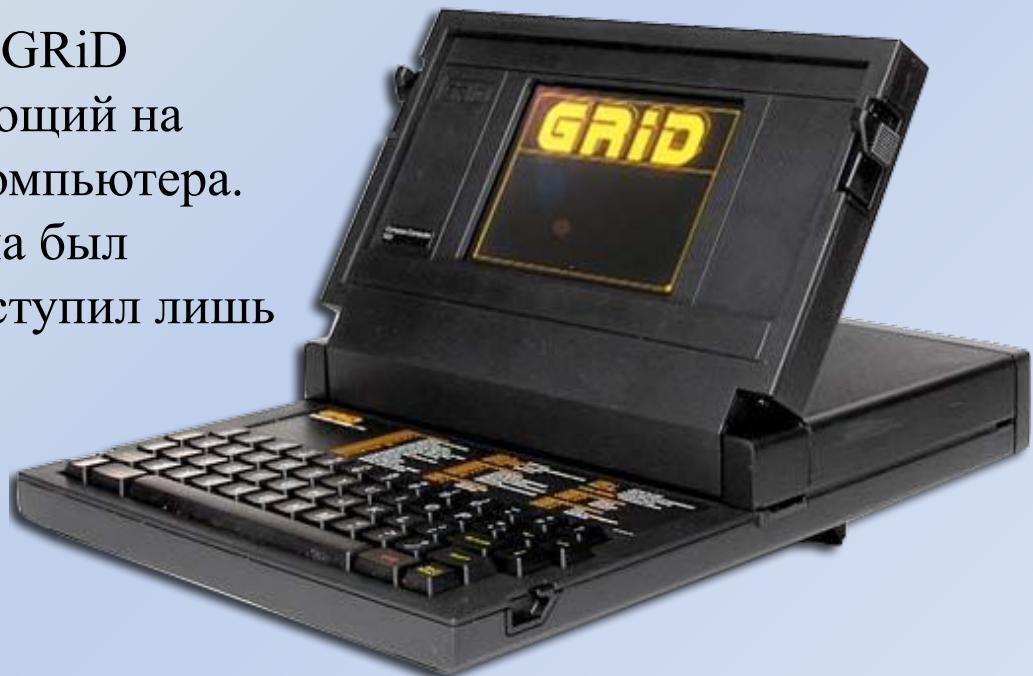
Конфигурацию GRiD Compass 1101 составляли следующие элементы: процессор Intel 8086 с тактовой частотой 8 МГц, 340 Кб дискового пространства , электролюминесцентный дисплей с разрешением 320x240 точек, модем со скоростью 1200 бод/с и прочный корпус из магниевого сплава. Весил около 5 кг.
