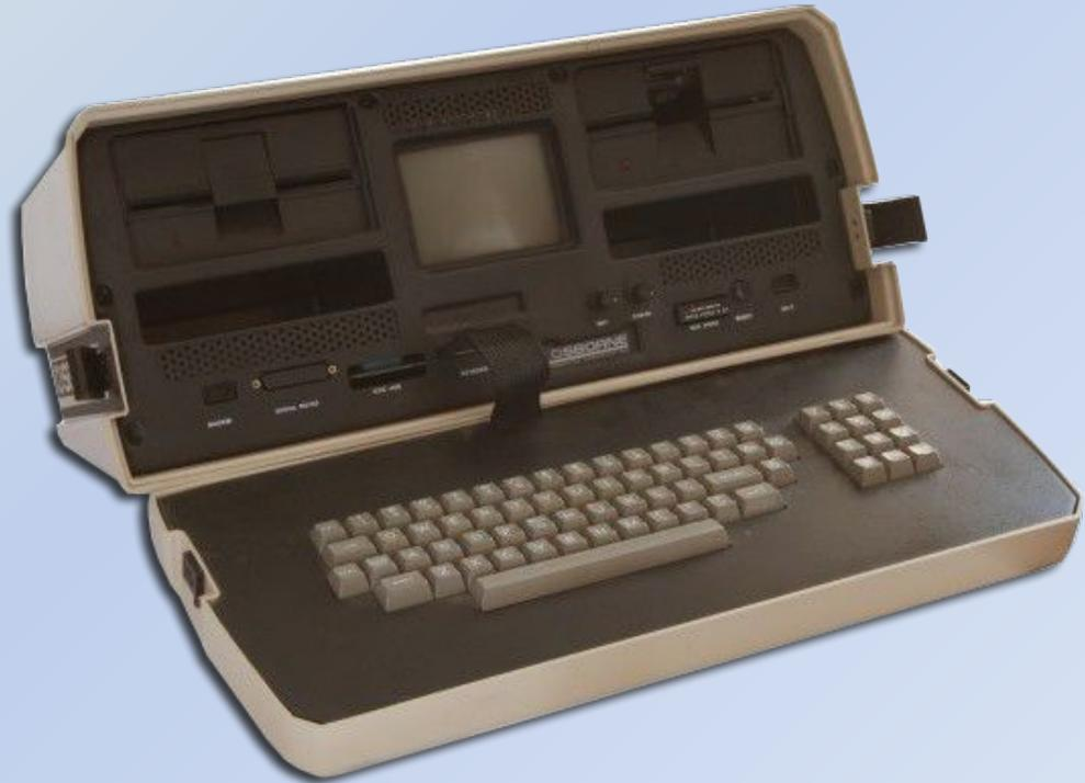
Весил 11 килограммов, комплектовался двумя приводами 5.25 – дисков, имел откидную клавиатуру-крышку, пятидюймовый монитор и ручку для переноски.
