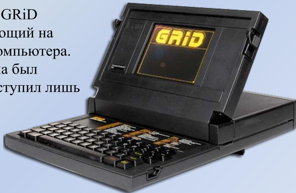
Конфигурацию GRiD Compass 1101 составляли следующие элементы: процессор Intel 8086 с тактовой частотой 8 МГц, 340 Кб дискового пространства, электролюминесцентный дисплей с разрешением 320x240 точек, модем со скоростью 1200 бод/с и прочный корпус из магниевого сплава. Весил около 5 кг.
