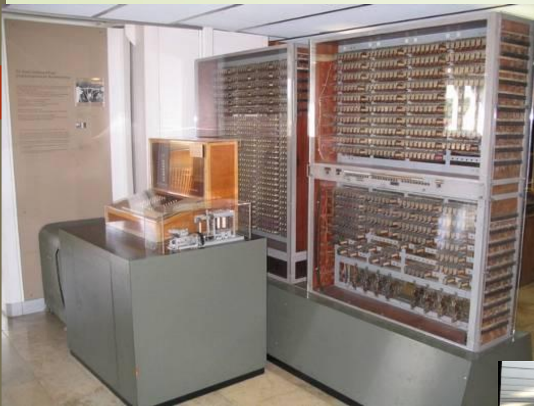
Релейная вычислительная машина – Z3
