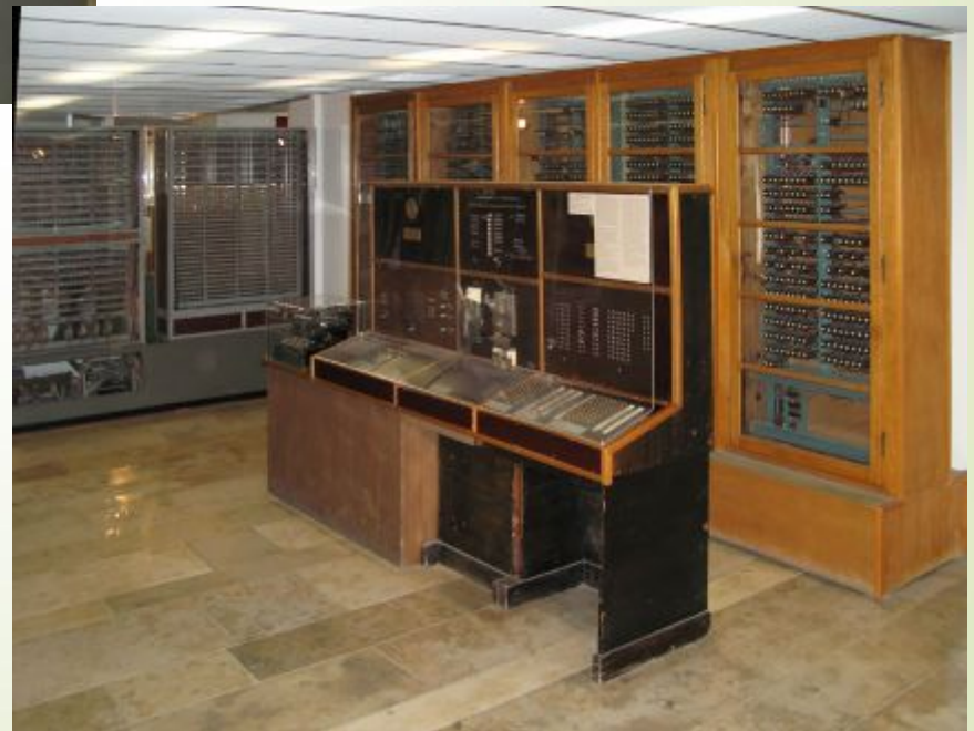
Релейная вычислительная машина – Z4
