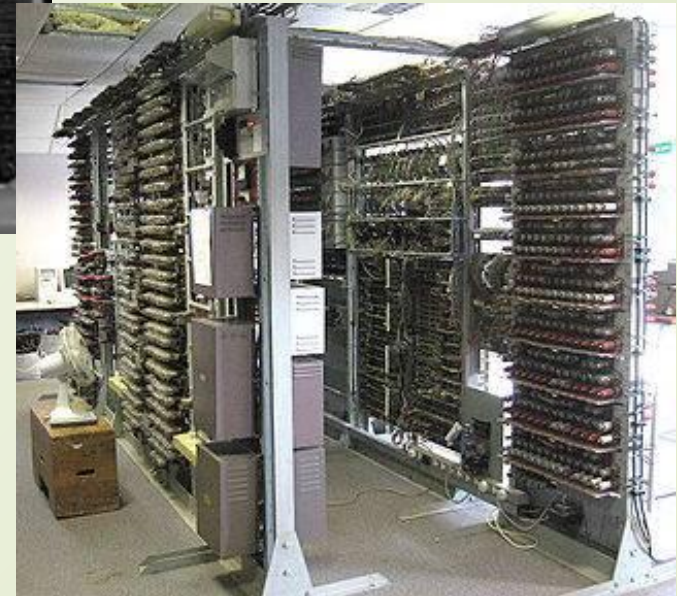
специализированная цифровая вычислительная машина "Колоссус" на электронных лампах (2000 ламп!).
