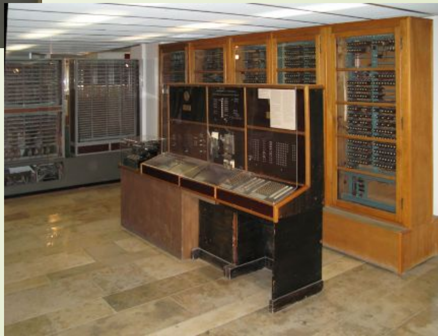
Релейная вычислительная машина – Z4
