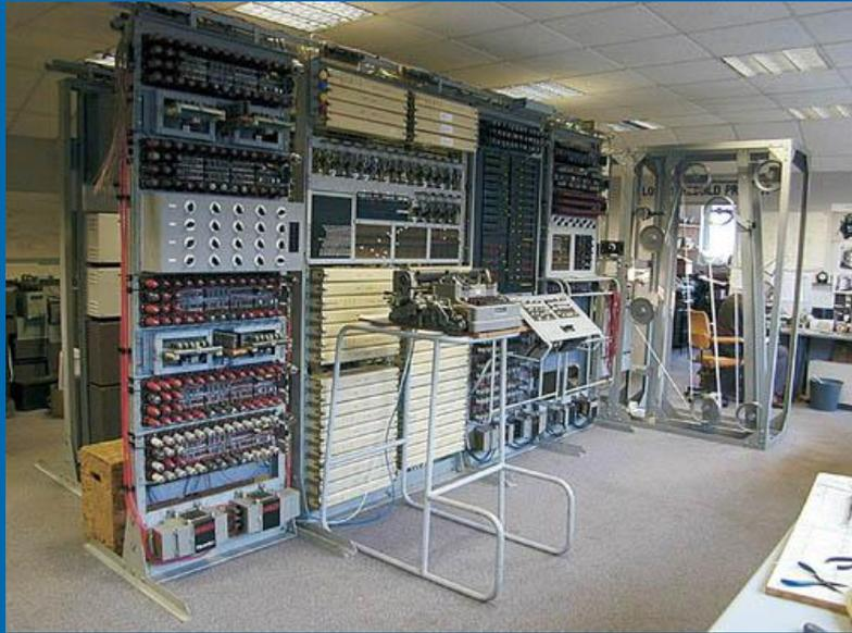
1942-1943 гг. В Англии при участии Алана Тьюринга была создана вычислительная машина "Colossus". В ней было уже 2000 электронных ламп. Машина предназначалась для расшифровки радиোগрамм германского Вермахта.
