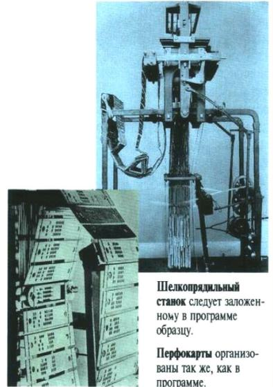
Шелкопрядильный станок следует заложенному в программе образцу.
