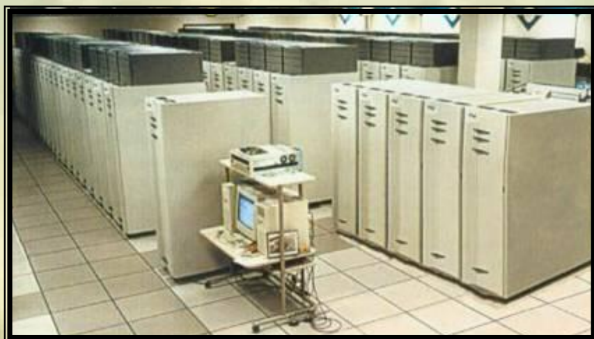
Суперкомпьютер ASCI Red. 1996 г. Имел в марте 2000 г. 9636 процессоров.
