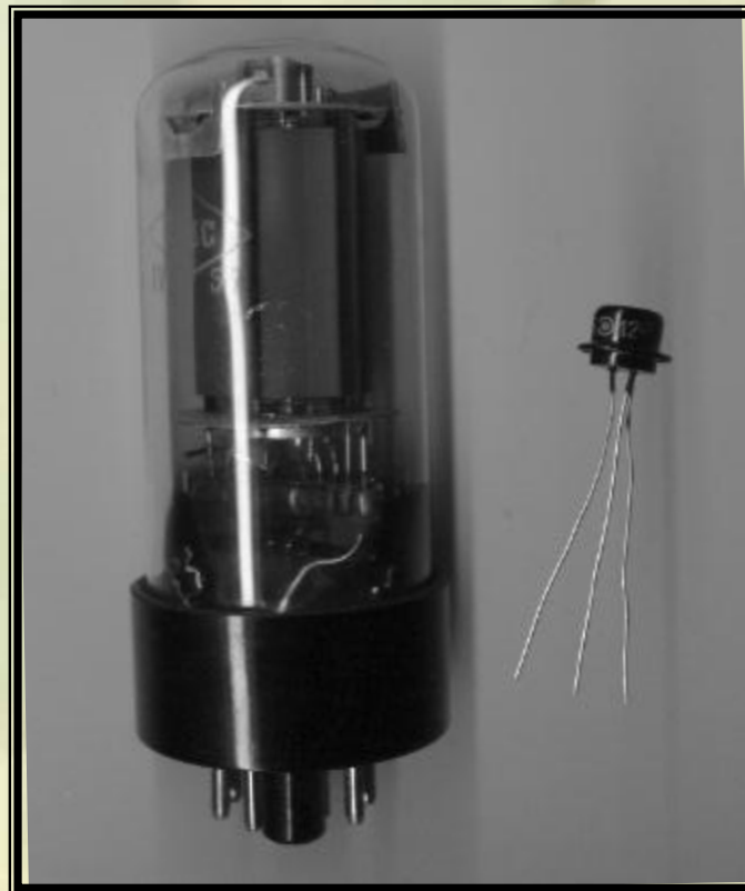
Вакуумная лампа (слева) и транзистор
