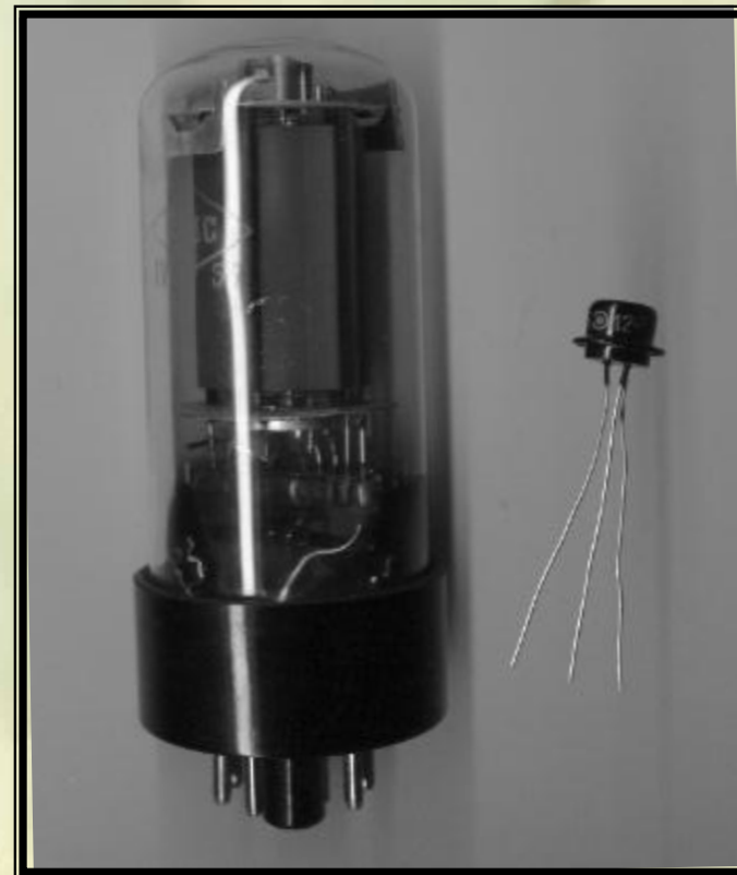
Вакуумная лампа (слева) и транзистор
