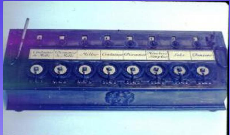
Она представляла собой легкий латунный ящичек размером 350x125x75 мм. На верхней крышке 8 круглых отверстий, вокруг каждого нанесена круговая шкала. Шкала крайнего правого отверстия разделена на 12 равный частей, шкала соседнего с ним отверстия — на 20 частей, шкалы остальных 6 отверстий имеют десятичное деление. Такая градуировка соответствует делению ливра — основной денежной единицы того времени — на более мелкие: 1 су=1/20 ливра и 1 денье=1/12 су.
