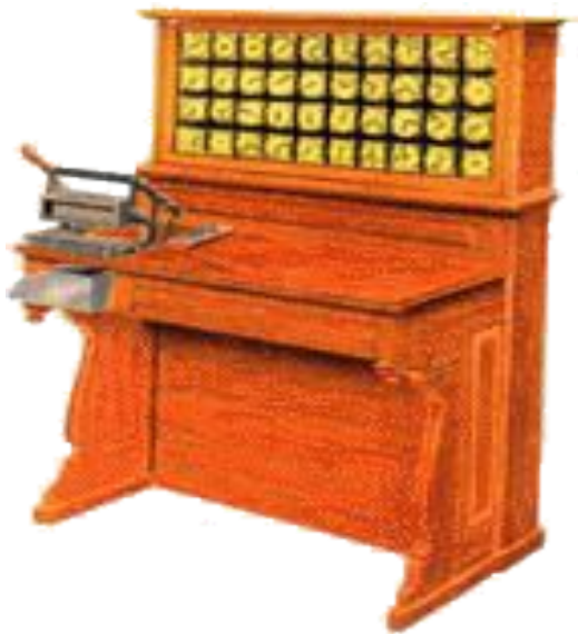
Станок для подготовки перфокарт
