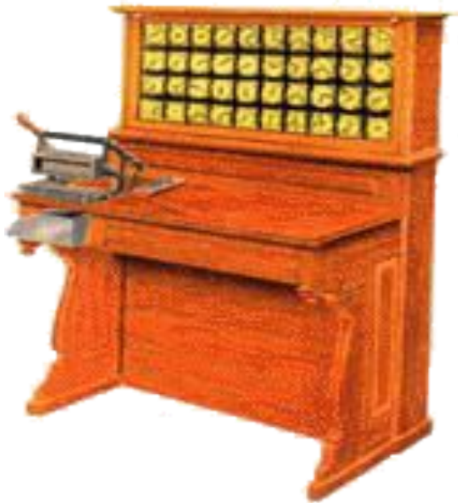
Станок для подготовки перфокарт
