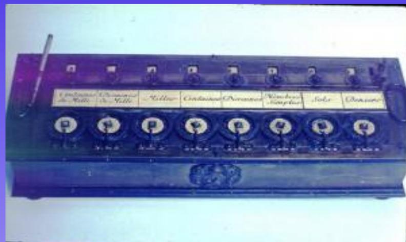
Она представляла собой легкий латунный ящик размером 350x125x75 мм. На верхней крышке 8 круглых отверстий, вокруг каждого нанесена круговая шкала. Шкала крайнего правого отверстия разделена на 12 равных частей, шкала соседнего с ним отверстия — на 20 частей, шкалы остальных 6 отверстий имеют десятичное деление. Такая градуировка соответствует делению ливра — основной денежной единицы того времени — на более мелкие: 1 су=1/20 ливра и 1 денье=1/12 су.
