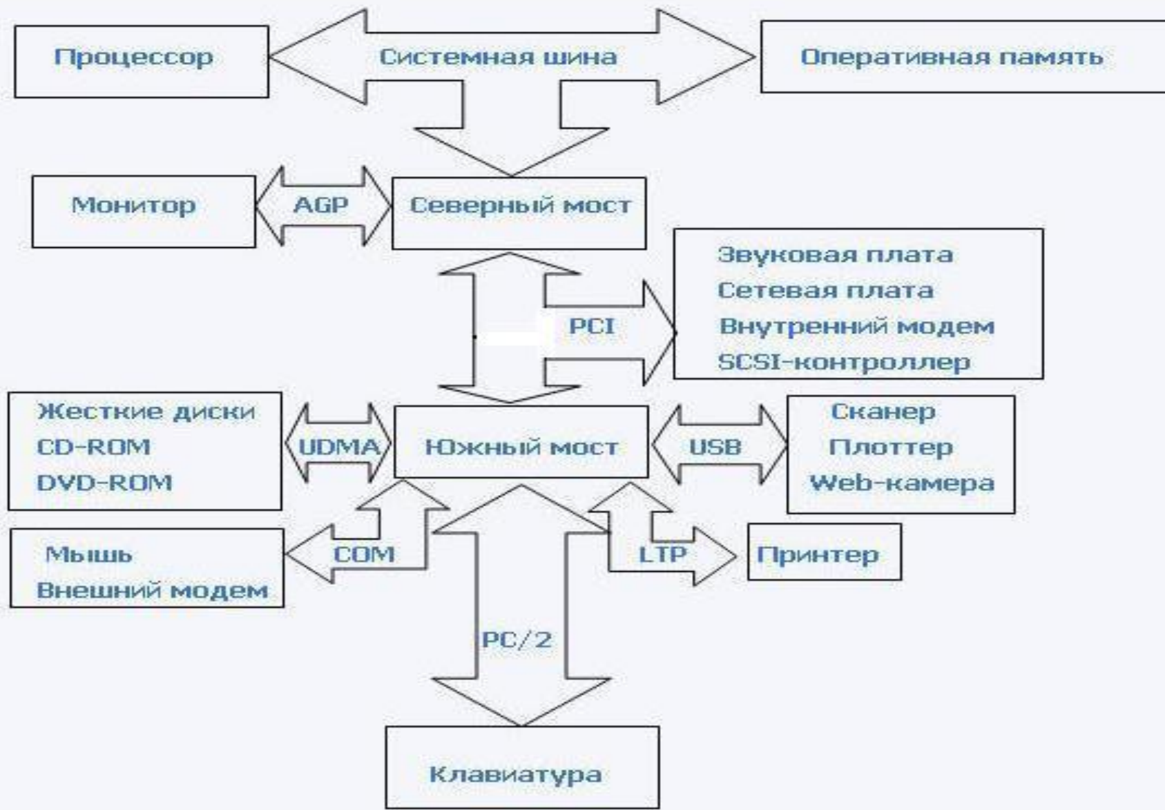
Логическая схема системной платы
