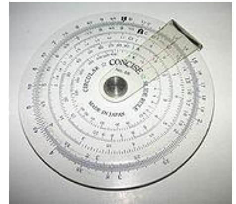
Круглая логарифмическая линейка
