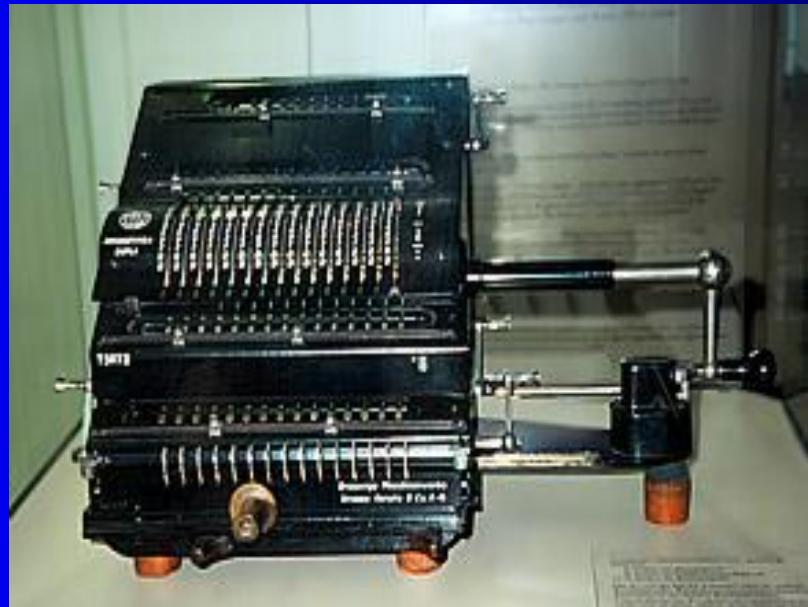
Механические счетные машины – АРИФМОМЕТРЫ – с видоизмененными "колесами Лейбница" использовались до середины XX столетия, пока не были вытеснены электрическими цифровыми вычислителями, а впоследствии современными электронными калькуляторами.
