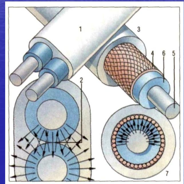
Основное назначение коаксиального кабеля — передача сигнала в различных областях техники
