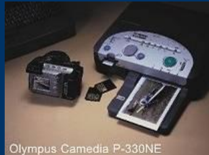
Рис 1.6. Сублимационная (термодиффузионная) печать
