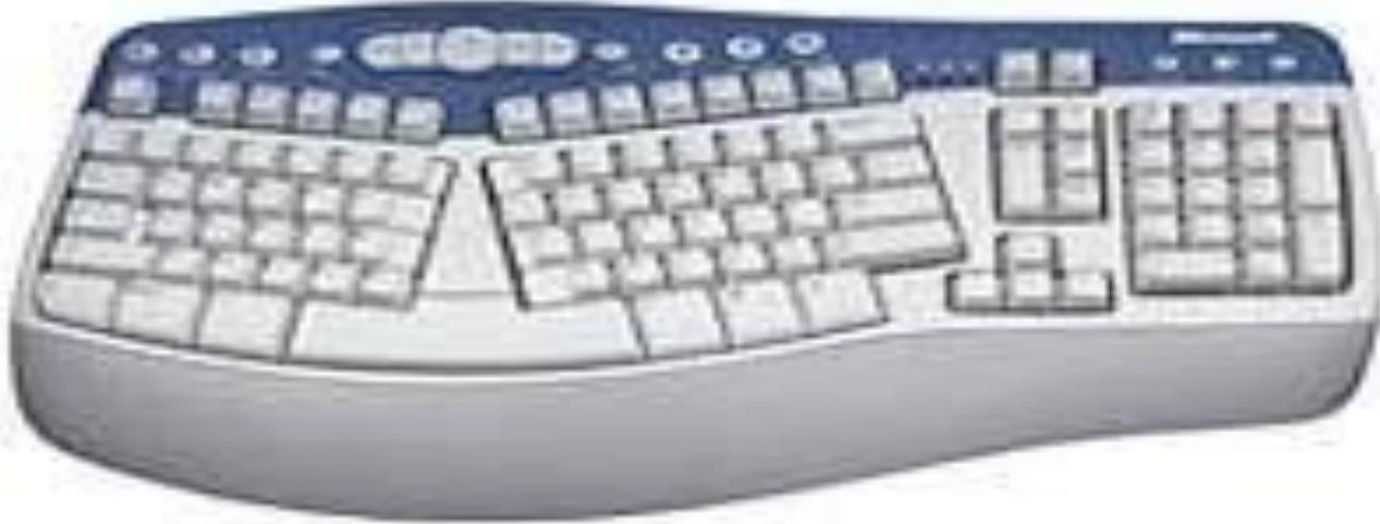
это компьютерное устройство, которое служит для набора текстов и управления компьютером.
