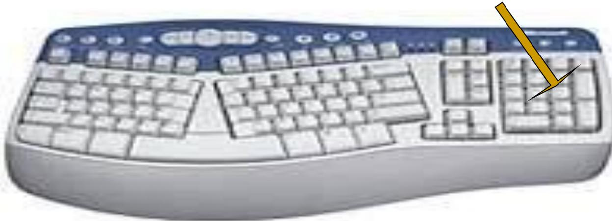
при включенном индикаторе Num Lock удобная клавишная панель с цифрами и знаками арифметических операций. Расположенными, как на калькуляторе. Если индикатор Num Lock выключен, то работает только режим управления курсором.
