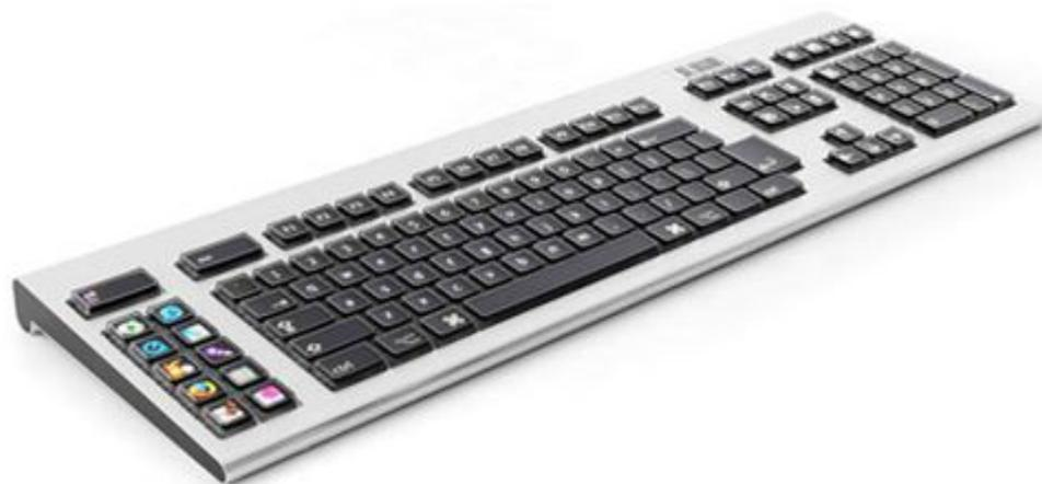
**Мембранная клавиатура** - наиболее доступная и дешевая технология, подразумевающая **замыкание двух мембран** расположенных на пластиковой основе. При нажатии на кнопку происходит соединение двух контактов через отверстие в пленке, разделяющей мембраны. Для возвращения кнопки в исходное положение используется мягкий **резиновый купол**.
