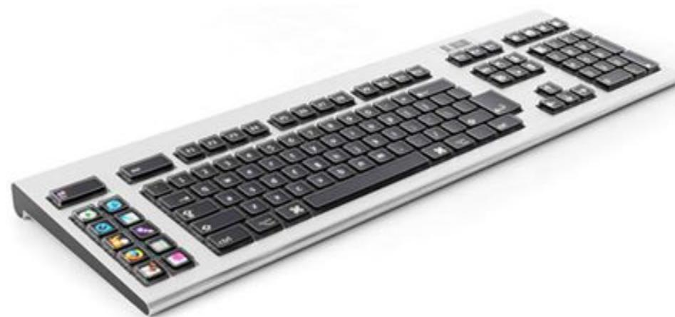
**Мембранные клавиатуры** - наиболее доступная и дешевая технология, подразумевающая **замыкание двух мембран** расположенных на пластиковой основе. При нажатии на кнопку происходит соединение двух контактов через отверстие в пленке, разделяющей мембранны. Для возвращения кнопки в исходное положение используется мягкий **резиновый купол**.
