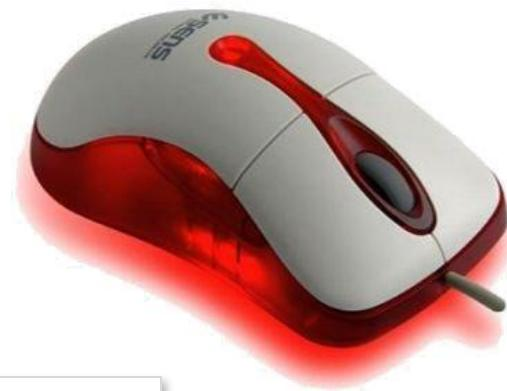
**Лазерная мышь** - усовершенствованный вариант предыдущей технологии, где для подсветки используется полупроводниковый лазер. Преимущества: возможность работы на стеклянных и зеркальных поверхностях (что недоступно для оптических мышек), более высокая точность, малое энергопотребление. Единственный недостаток - цена, которая несколько выше стоимости обыкновенной оптической мышки со светодиодом.
