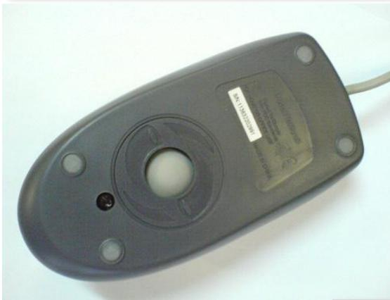
**Оптическая мышь** - сложное устройство, состоящее из нескольких элементов, взаимосвязанных и взаимодействующих между собой. Основой является миниатюрная камера, которая фотографирует рабочую поверхность, подсвеченную светодиодом, более тысячи раз в секунду. Данные посылаются процессору, который анализирует изменения и перенаправляет обработанный сигнал к ПК. Преимущества технологии: возможность работы на поверхностях практически любого рода, легкость, доступность.
