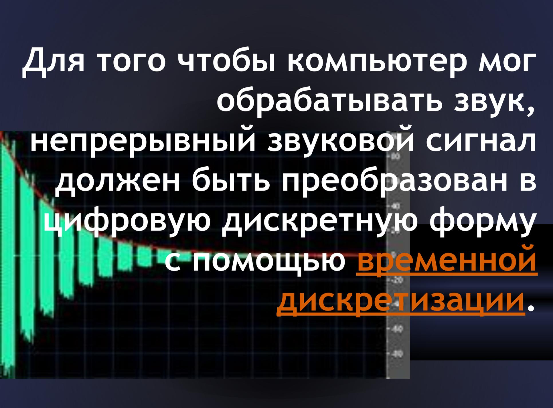
Для того чтобы компьютер мог обрабатывать звук, непрерывный звуковой сигнал должен быть преобразован в цифровую дискретную форму с помощью временной дискретизации.
