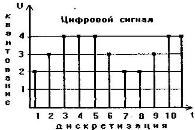
После такого преобразования непрерывный сигнал представляют последовательностью чисел. Показанный на рисунке непрерывный сигнал заменяется числами 2-3-4-4-4-3-2-2-3-4-4 (так производится квантование по уровням). Затем десятичные числа кодируются последовательностью единиц и нулей. Чем больше уровней и выше частота выборок сигналов, тем выше качество кодирования.
