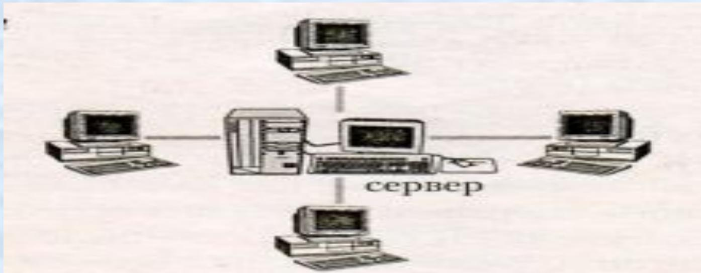
При использовании архитектуры «Звезда», каждый компьютер подключен к специальному концентратору («хабу»). Преимуществом этой архитектуры является устойчивость к повреждениям кабеля – при обрыве перестает работать только один из узлов сети.
