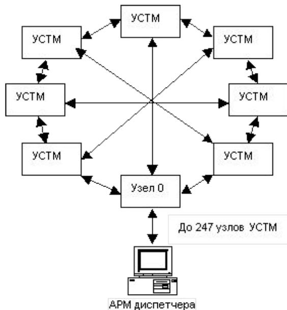
**Архитектура с несколькими мастер-узлами, многоточечным соединением и децентрализованным управлением обменом**
