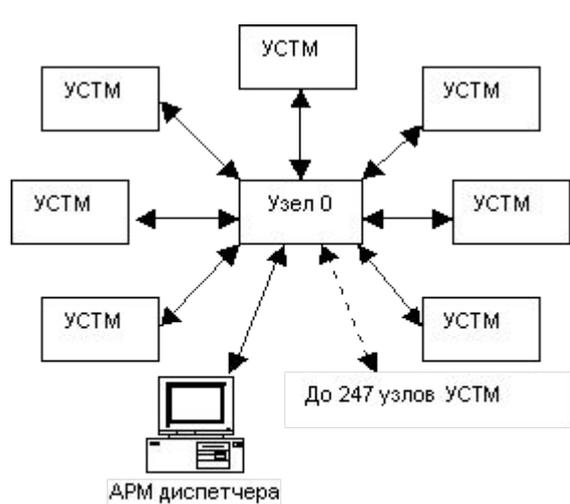
**Архитектура с радиальными связями, несколькими мастер-узлами и децентрализованным управлением обменом**
