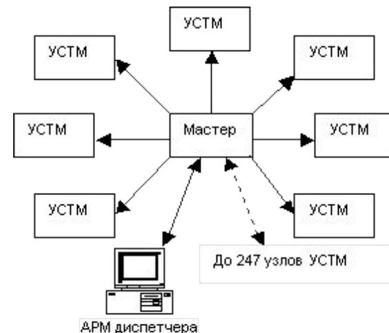
**Архитектура с радиальными связями, одним мастер-узлом и централизованным опросом**
