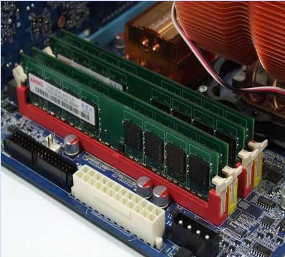
**Оперативная память** (ОЗУ), - это быстрое запоминающее устройство, непосредственно связанное с процессором и предназначенное для записи, считывания и хранения выполняемых программ и данных, обрабатываемых этими программами.
