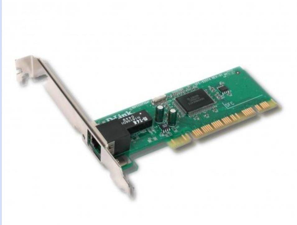
Каждый компьютер, подключенный к сети должен иметь специальную плату (**сетевой адаптер**), соединение компьютеров между собой производится с помощью кабеля различных типов (коаксиального, витой парой, оптоволоконного).
