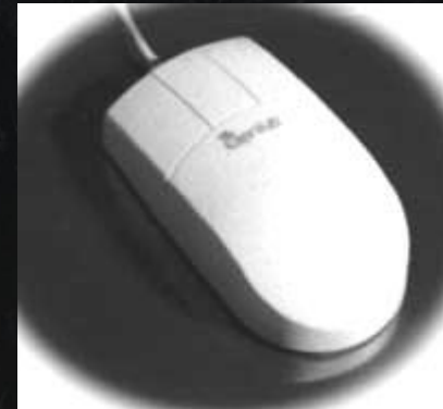
Genius MyMouse Optical - оптическая мышь, у которой вместо шарика в корпусе имеется отверстие, через которое видны два ярких красных светодиода и два фотоприемника
