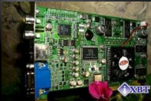
Видеокарта RADEON 64MB DDR VIVO
