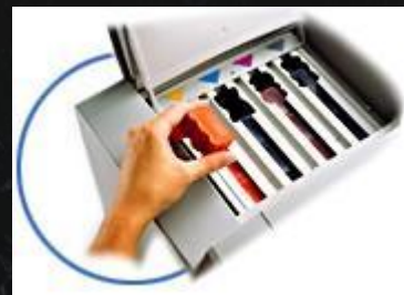
Заправка краски в твердокрасочный принтер
