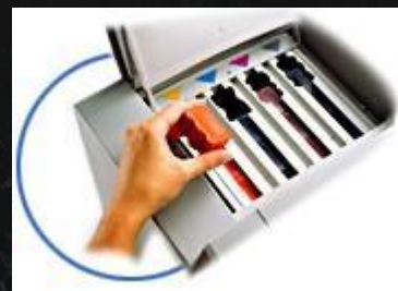
Заправка краски в твердокрасочный принтер
