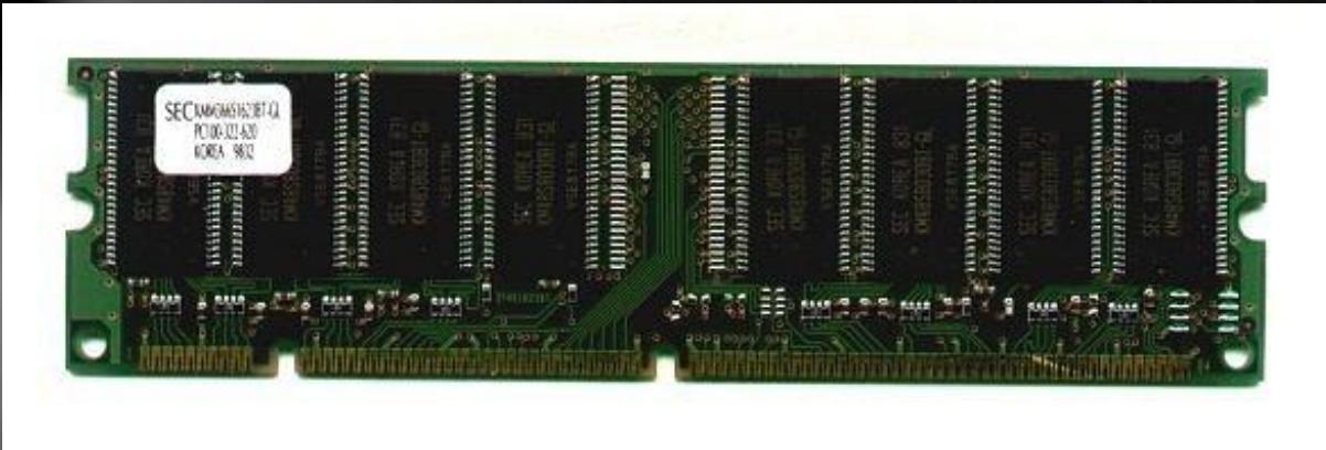
Практически любой компьютер оснащен оперативной памятью, выполненной на микросхемах. Она состоит из определенного количества ячеек памяти, каждая из которых имеет свой собственный адрес или просто номер в двоичном коде. Оперативная память предназначена в основном для хранения выполняемых программ и их данных в течение всего времени, пока компьютер работает. Она подобна грифельной доске, информация на которой постоянно вытирается, заменяется новой и полностью исчезает после выключения компьютера.
