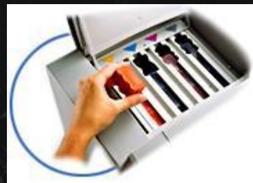
Заправка краски в твердокрасочный принтер
