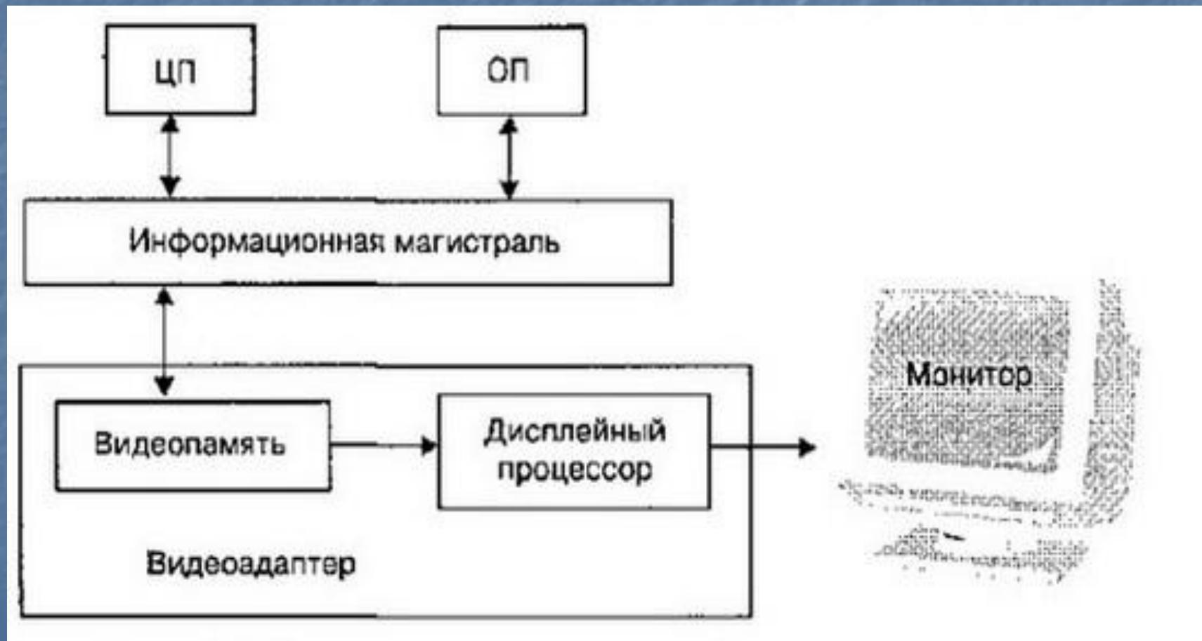
*Видеoadаптер* – устройство, управляющее работой графического дисплея. Видеoadаптер состоит из двух частей: видеопамяти и дисплейного процессора.
