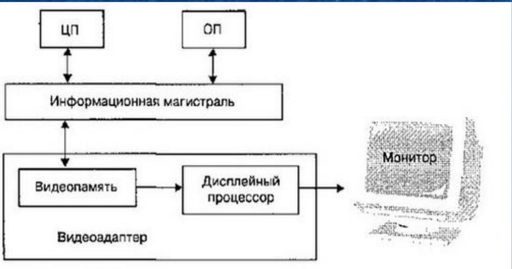
*Видеоадаптер* – устройство, управляющее работой графического дисплея. Видеоадаптер состоит из двух частей: видеопамати и дисплейного процессора.
