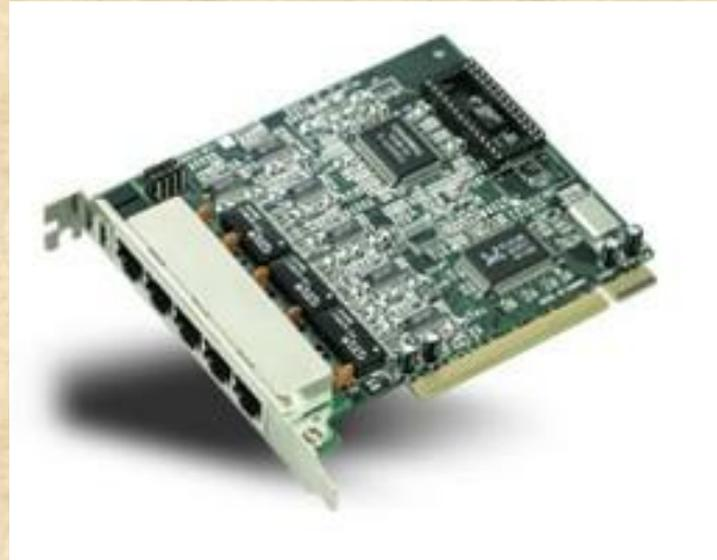
Устройство для объединения компьютеров в сеть Ethernet с применением кабельной инфраструктуры типа **витая пара**.
