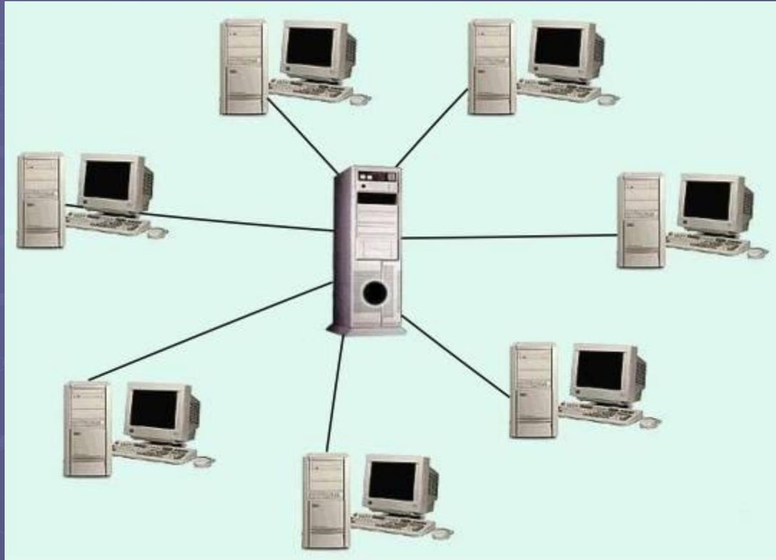
Рабочие станции подключаются непосредственно к файл-серверу, но не соединены друг с другом.
