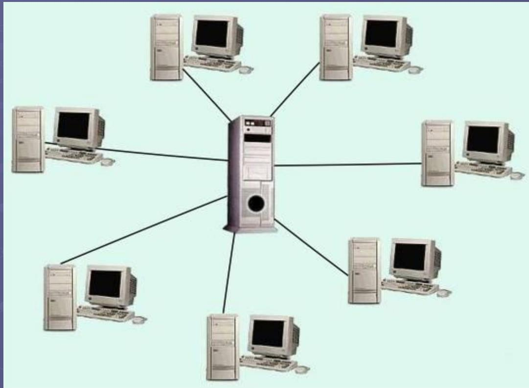
Рабочие станции подключаются непосредственно к файл-серверу, но не соединены друг с другом.
