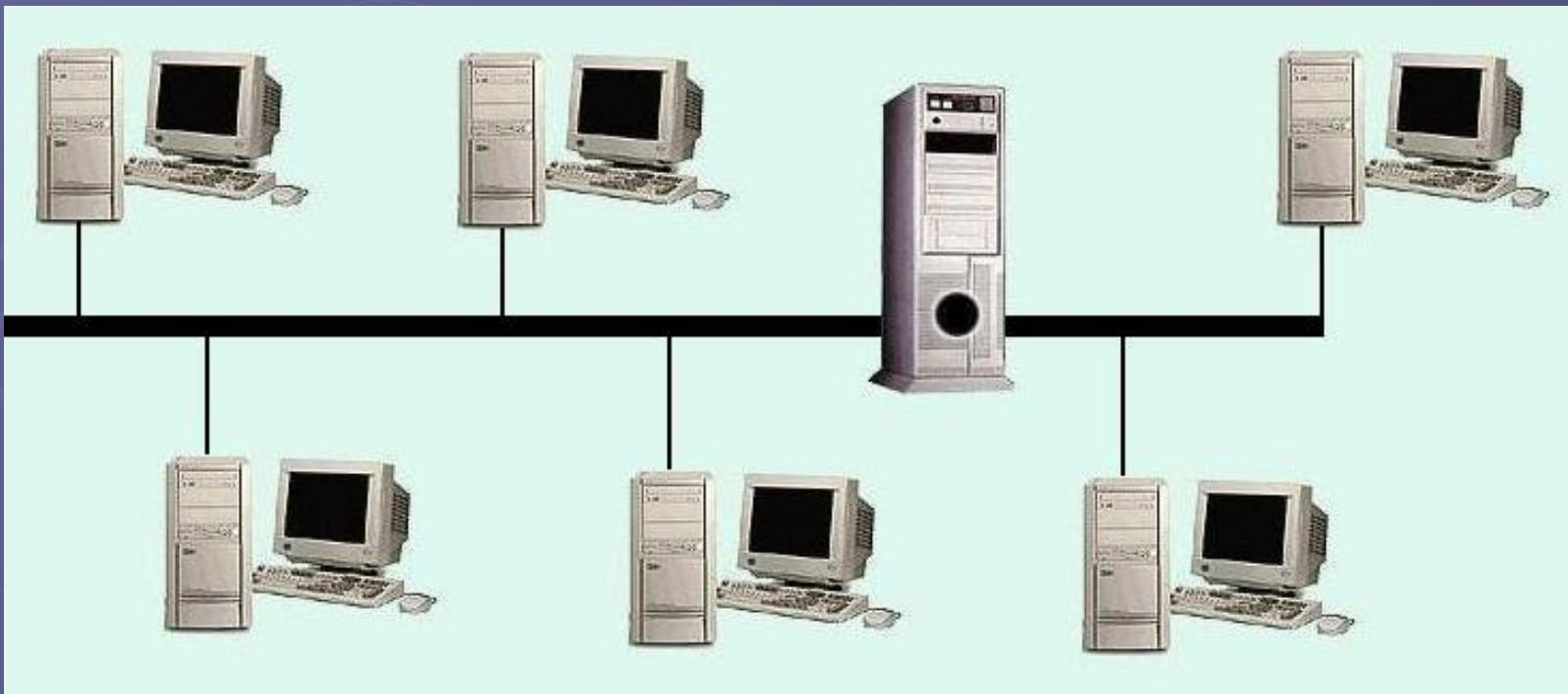
Рабочие станции и файл-сервер подключаются к центральному кабелю, называемому шиной.
