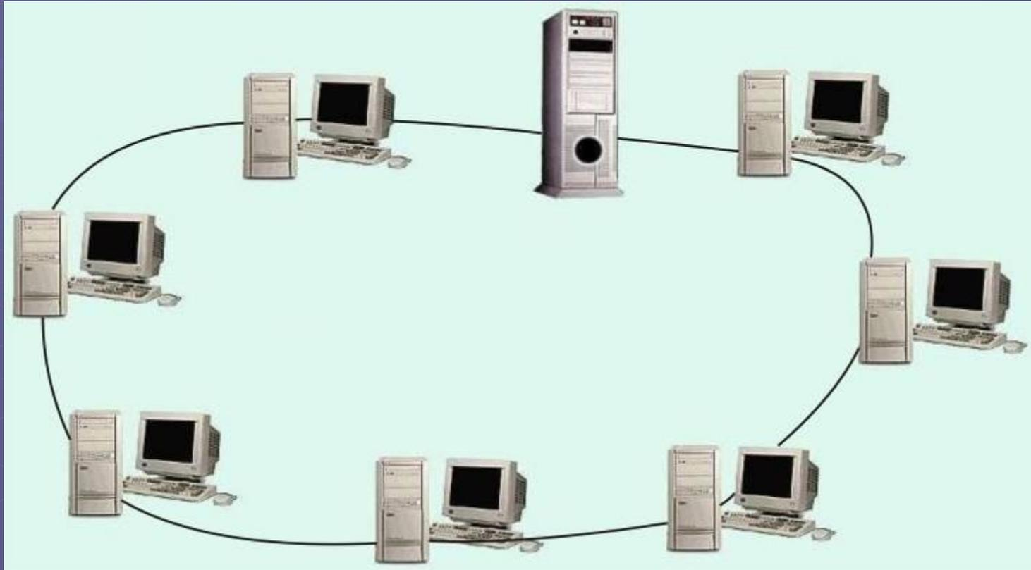
Файл-сервер и рабочие станции соединены кабелем в кольцо. Сообщения рабочей станции могут проходить через несколько других рабочих станций до того, как они достигнут файл-сервера.
